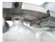
氮氣充氮隧道
